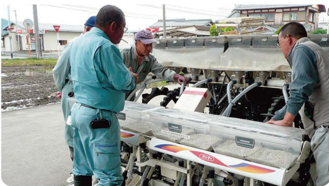
直播田植機の点検作業
