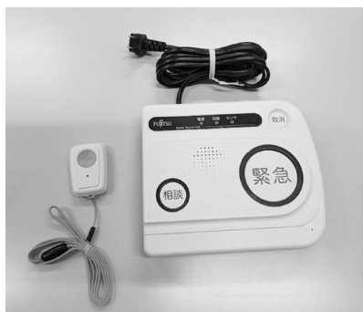
緊急通報システムの固定型装置
