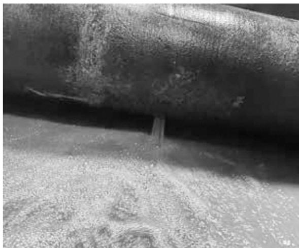
送水管に約5cmの穴が開き漏水が発生した
